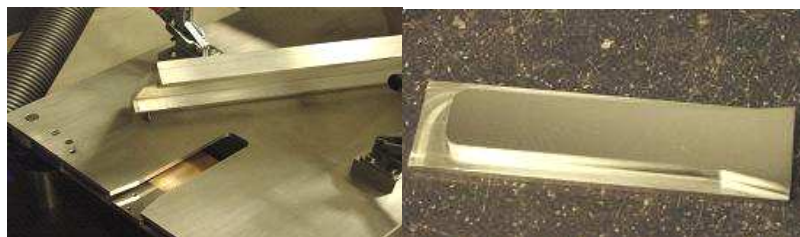
Figuur 8: In de onderplaat van de flowcel (links) is een uitsparing gemaakt waar een monsterplaat (rechts) precies in past. De RVS monsterplaten zijn extreem glad gepolijst om een goede analyse onder de microscoop mogelijk te maken. Vloermaterialen, daarentegen, zijn niet behandeld voor de testen.
