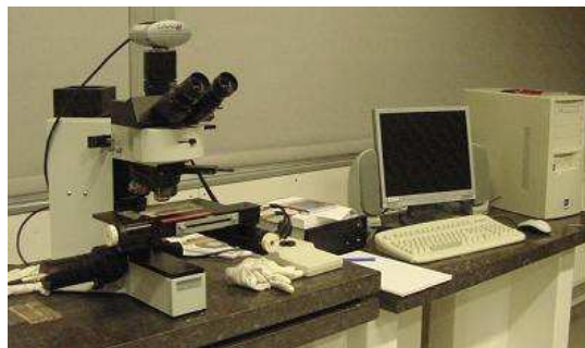
Figuur 10 De microscoop met digitale camera en bijbehorende hard- en software.
