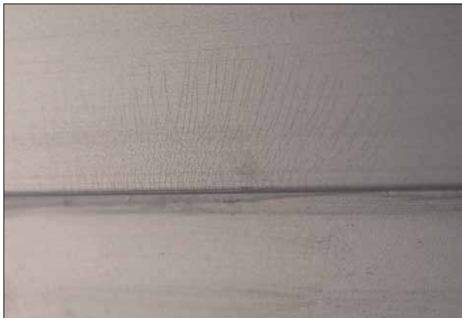
Figuur 3: Foto van microscopisch kleine barstjes in het geanodiseerde aluminium die tijdens de proef niet veranderden.
