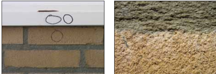
Figuur 2: Foto's gelakt kozijn na 120 cycli. Links kozijn met op een plaats een gebarsten verflaag, naar alle waarschijnlijkheid door een onregelmatigheid in het hout. Op de foto rechts een detailfoto van de lichte witte verkleuring van de baksteen.
