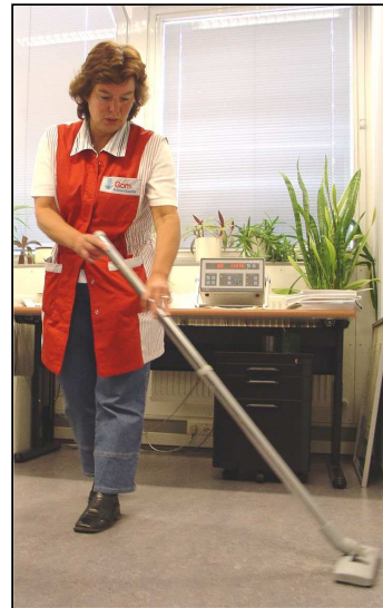
Fig. 12: Hoeveel deeltjes vrijkomen door het lopen van de schoonmaakster en de bewegingen die zij maakt is gemeten door het stofzuigen te simuleren met alleen de buis in de hand. Metingen met het mondstuk juist boven en gewoon op de vloer geven een indicatie van de hoeveelheid deeltjes die vrijkomen door het schuiven van het mondstuk over de vloer (deze situatie is gefotografeerd)
