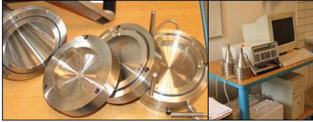
De Anderson Sampler, links in onderdelen en rechts tweemaal op een meetkar naast de deeltjesteller
