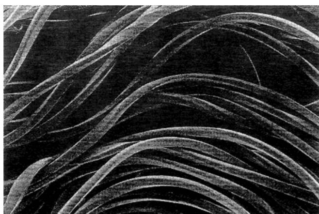
Figuur III.23: Doekje K, overlangsopname kettingdraden.
