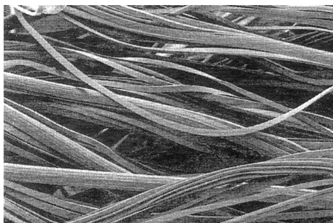
Figuur 2: Elektronenmicroscopische opname in de lengterichting van microvezeldoekje A (ongewassen), 320 maal vergroot, die gesplitste en ongesplitste inslagdraden toont.
